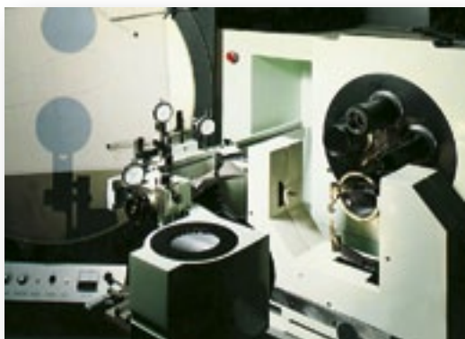
▲ Dispositivo P4N , comprendente il supporto palette ed il tastatore-ripetitore per il controllo di palette singole.
